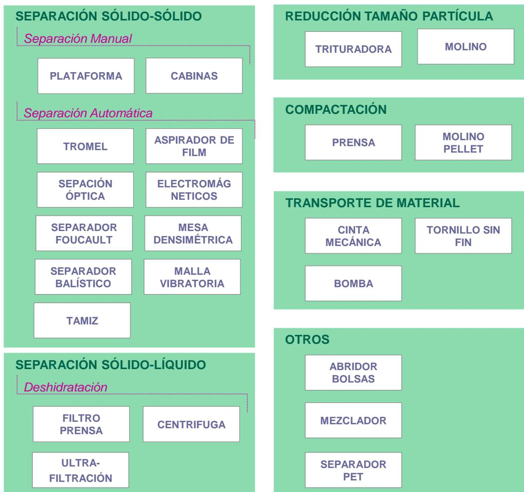
Figura 23. Resumen de equipamiento típico en un proceso de tratamiento mecánico. Fuente: Elaboración propia.
