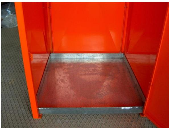
Una vez en el lugar de fijación, se marcan los orificios del contenedor en el suelo y se hace un orificio para instalar un taco del 8 o 10. Se ancla en contenedor al suelo por los 4 puntos y se pone la bandeja encima de los tornillos. Es aconsejable poner una banda de goma de 1mm de grosor entre el contenedor y el suelo.
